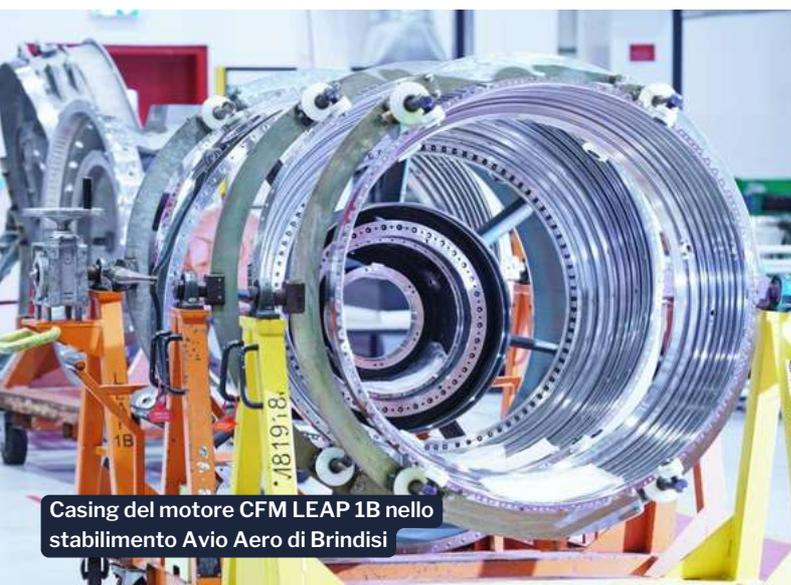
Casing del motore CFM LEAP 1B nello stabilimento Avio Aero di Brindisi
