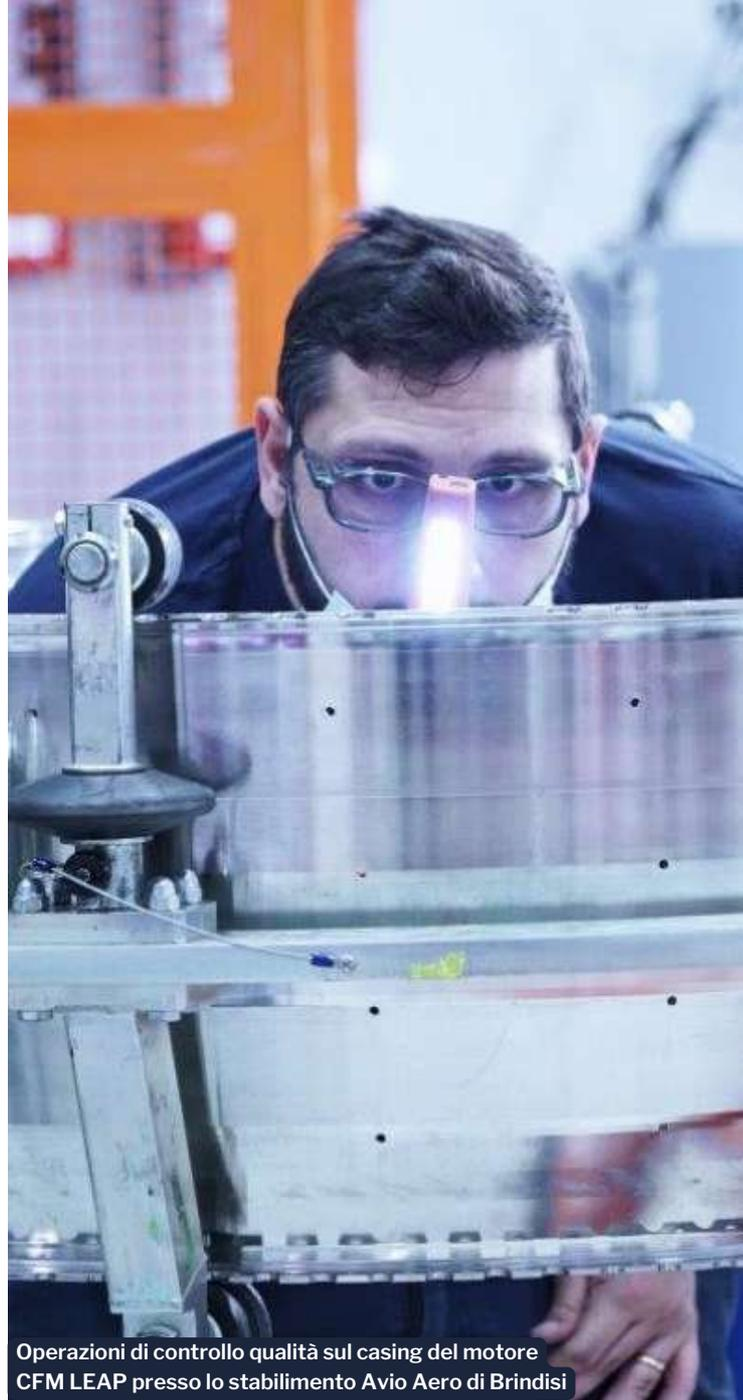
Operazioni di controllo qualità sul casing del motore CFM LEAP presso lo stabilimento Avio Aero di Brindisi
