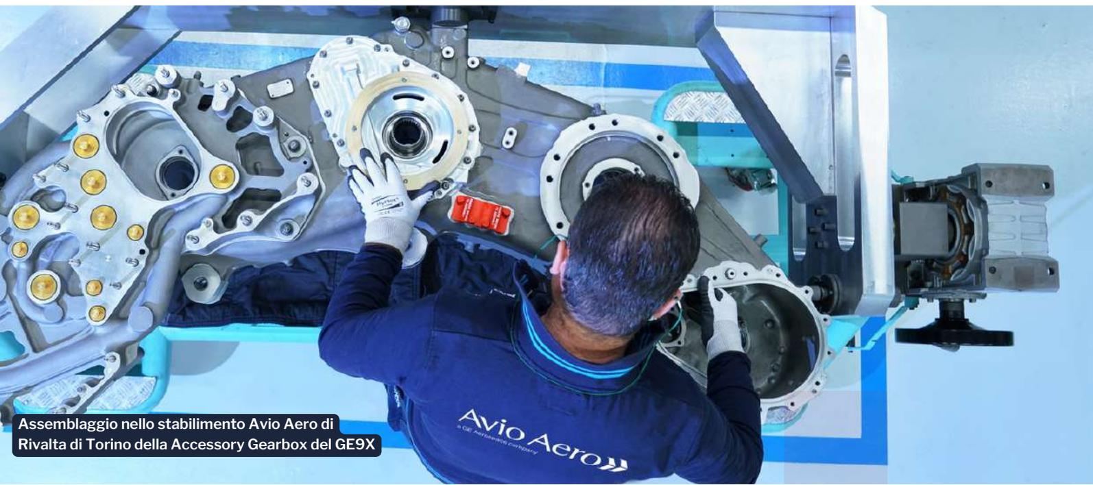
Assemblaggio nello stabilimento Avio Aero di Rivalta di Torino della Accessory Gearbox del GE9X
